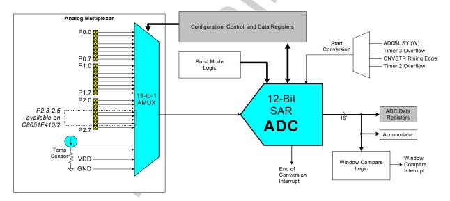
Figure 1.7. 12-Bit ADC Block Diagram
