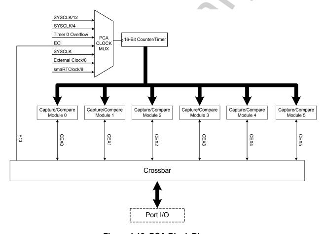
Figure 1.12. PCA Block Diagram
