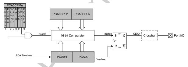
Figure 25.9. PCA 16-Bit PWM Mode
