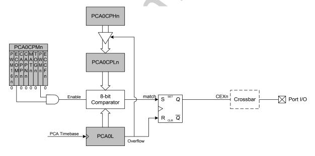
Figure 25.8. PCA 8-Bit PWM Mode Diagram
