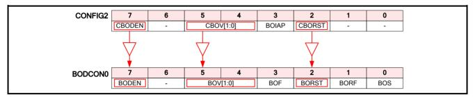
Figure 29.2. CONFIG2 Power-On Reset Reloading
