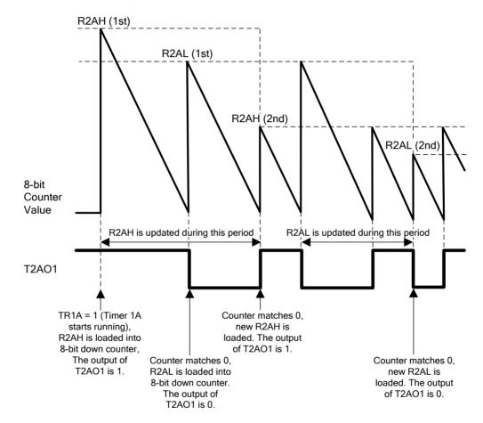
Figure 10.3. Timer 2A PWM Waveform
